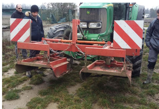
Double gyro-broyeur autoconstruit
